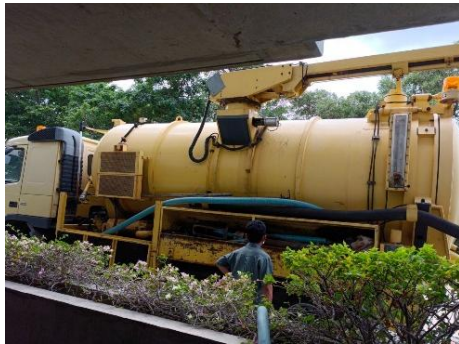
รูปที่ 49 การสูบน้ำออกจากระบบบำบัดน้ำเสีย
